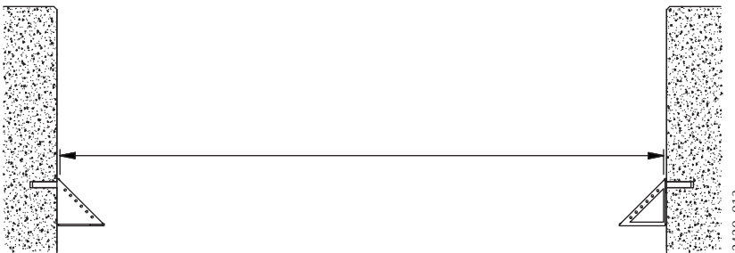
Bild 13. Mått för tillkapning av primärplank
